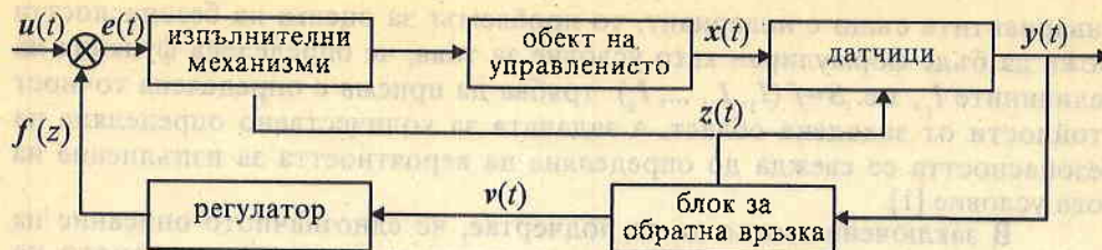
фиг.1. Обобщена структура на отказоустойчива система
